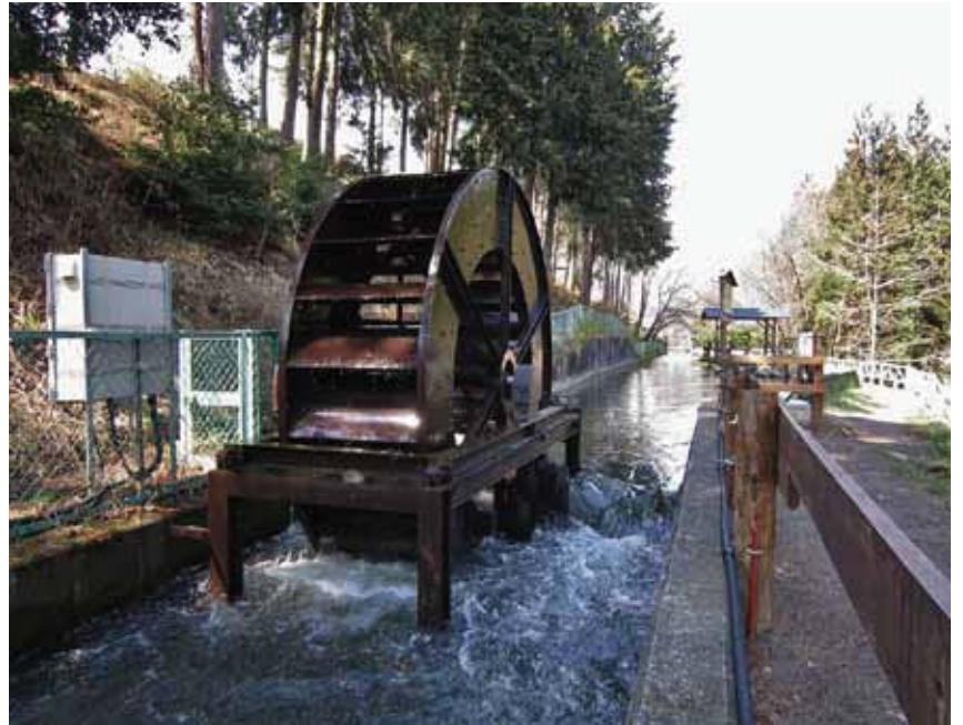
長野県松本市の波田水車（出力 0.8kW）
